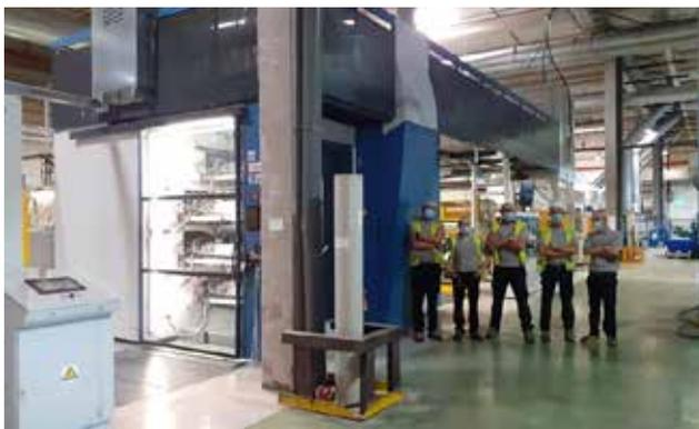
Prensa flexográfica banda ancha de 8 colores (CMYK-OGV-W)
